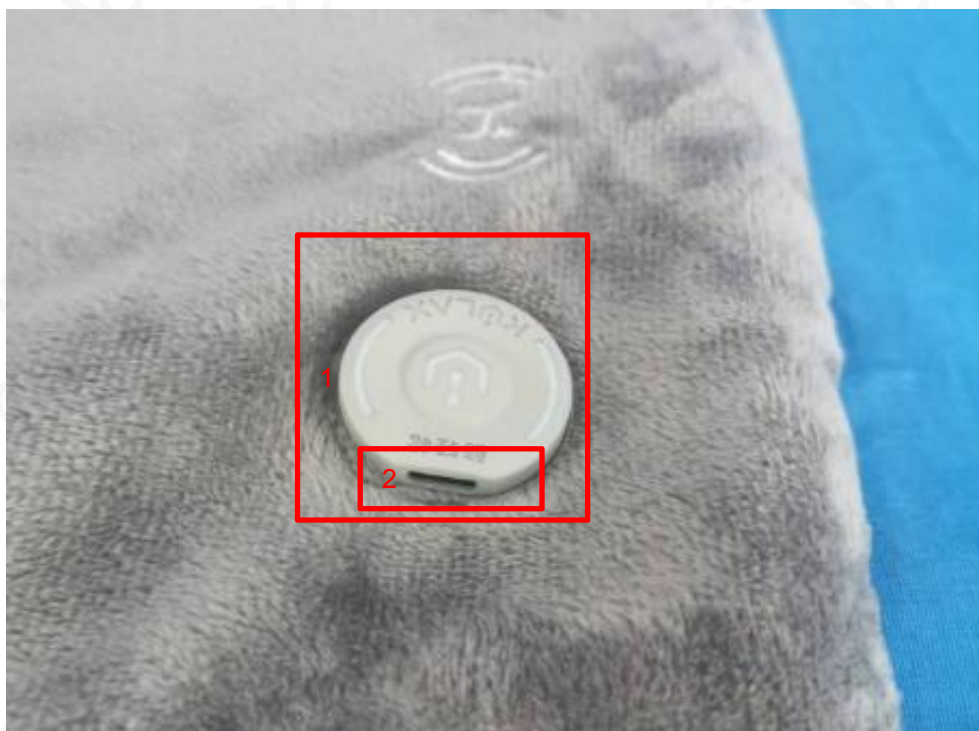
图 3、输入端口及开关按钮 (红框 1 为开关按钮, 红框 2 为输入端口)
